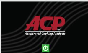
Le four doit être branché. (L'écran s'allumera en « Mode veille » au bout de 30 secondes environ.)
