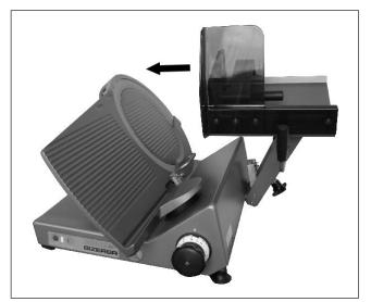
Fig. 99: Tilt carriage inwards GSP H
