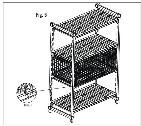
6. Вставьте клеть между полками секции стеллажа Camshelving®. Металлические стойки закрепляются крючками под передней и задней перекладинами (см. рис. 6A).
