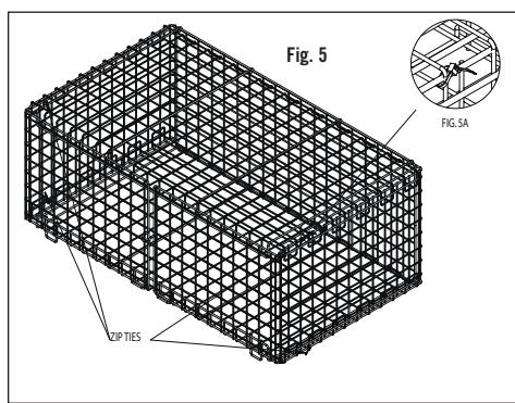
5. Sluit de bovenkant en zet de bovenkant, onderkant en zijkanten tijdelijk vast met de meegeleverde kabelbinders. (Fig. 5A)
