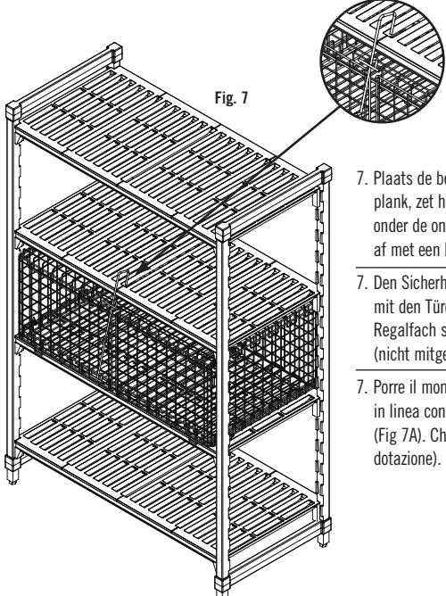
7. Plaats de beveiligingsstaander over de bovenste plank, zet hem in lijn met de deuren en zet hem onder de onderste plank vast (Fig 7A). Sluit de kooi af met een hangslot (niet meegeleverd).
