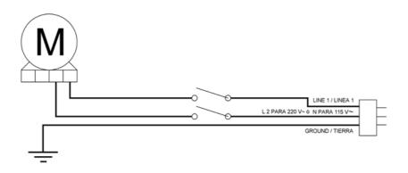
EL CAPACITOR NO REPRESENTADO EN EL DIAGRAMA ELECTRICO YA QUE ES PARTE DEL MOTOR.
