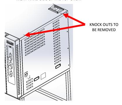
HOOK SMALL FLANGE HOOKS OF HEAT SHIELD INTO THE KNOCKOUT HOLES ON TOP RIGHT SIDE OF OVEN. SHIELD HANGS ON SIDE OF OVEN AS SHOWN.
