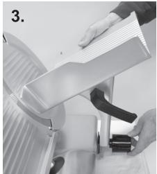
3. Retire el carro deslizante de alimentos desde la cortadora aflojando la perilla de desenganche del carro de deslizante de alimentos en el brazo del carro. **Nota:** La perilla para aflojar el carro deslizante de alimentos no está diseñada para ser retirada por completo. Levante el carro deslizante de alimentos completamente desde el brazo del carro.
